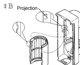
3. Remettre la lentille en place en alignant les 4 ergots du capot dans les 4 encoches de la lentille. S'assurer que la lentille est bien orientée dans sa position verticale lors de la pose.
