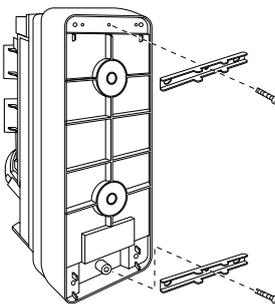
Appliquer les étriers en U sur le poteau à l'aide des vis M4X30 fournies. Fixer conformément aux procédures sur la fixation murale.
