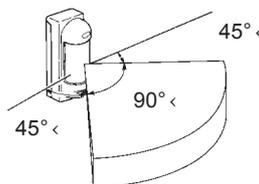
La zone de détection est de 90° avec 7 faisceaux espacés de 15°. Cette zone pivote de droite à gauche par cran de 15°. (Si vous voulez réduire les faisceaux, ajuster le lentille avec le masque de zone pourvu.)
