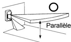
Si le détecteur est incliné par rapport au sol, la fiabilité de fonctionnement peut être réduite.
