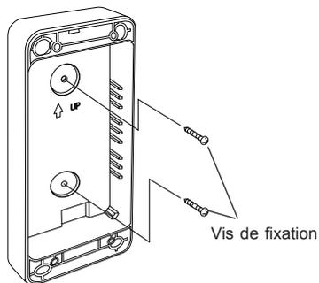
2 Guider le câble dans les encoches du détecteur par le passage de câble. Après avoir branché les fils sur le bornier (cf 4. cablage), appliquer le joint-mousse anti-eau de façon à ce qu'elle comble le passage du câble comme indiqué sur la figure. Fixer l'émetteur sur le réceptacle.
