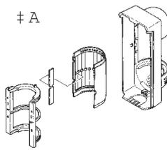
2. Séparer la lentille du capot. Positionner le cache fourni à l'intérieur de la lentille, de façon à masquer la zone souhaitée.
