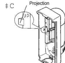
4. Remettre en place le support de lentille. Vérifier que le support de lentille est bien maintenu de chaque côté par les encoches du capot.
